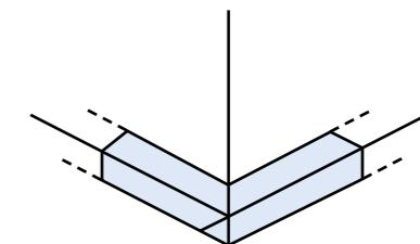
hová krytina se natírá stejným způsobem. Pro nátěr zdi je vhodný kulatý štětec s delším vlasem. Poté se natře rubová strana lišty. Je vhodné použít štětec o 1 cm užší než je šířka lišty. Při aplikacích většího rozsahu se doporučuje použití natíracího strojku.
