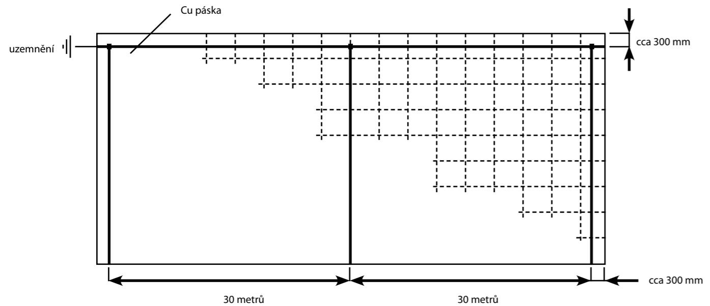
Štětcem se nanese tenká vrstva vodivého disperzního lepidla v šíři cca 3 cm, do které se vtlačí Cu páiska. Všechna křížící se místa se proletují. Vývody měděné pásky se provádějí rozpojitelné, opatřené rozpojitelnou svorkou pro kontrolu elektrického odporu. Tyto vývody jsou napojeny na hlavní ochrannou svorku ČSN 33 2000-5-54 (Uzemnění a ochranné vodiče). Po instalaci vodivé sítě se provede měření odporu R Cu-vodivé sítě.
