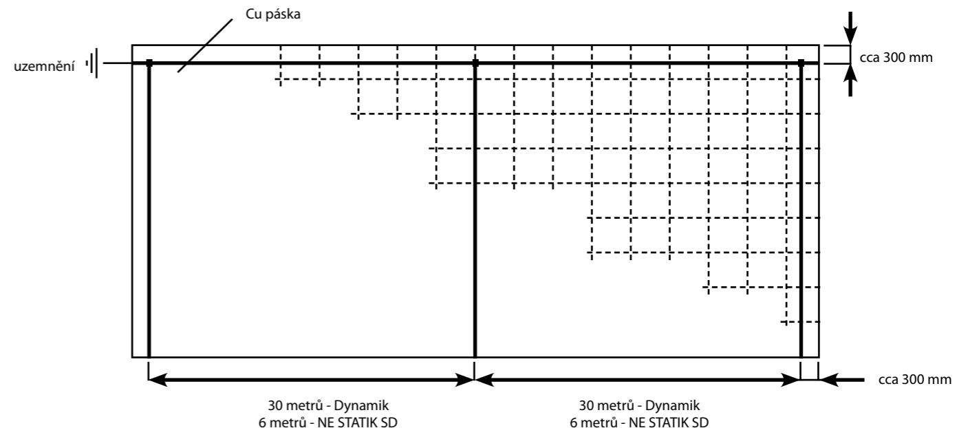
Štětcem se nanese tenká vrstva vodivého disperzního lepidla v šíři cca 3 cm, do které se vtlačí Cu páiska. Všechna křížící se místa se proletují podle bodu 9.1.1.1. Vývody měděné pásky se provádějí rozpojitelné, opatřené rozpojitelnou svorkou pro kontrolu elektrického odporu. Tyto vývody jsou napojeny na hlavní ochrannou svorku ČSN 33 2000-5-54 (Uzemnění a ochranné vodiče). Po instalaci vodivé sítě se provede měření odporu R Cu-vodivé sítě.
