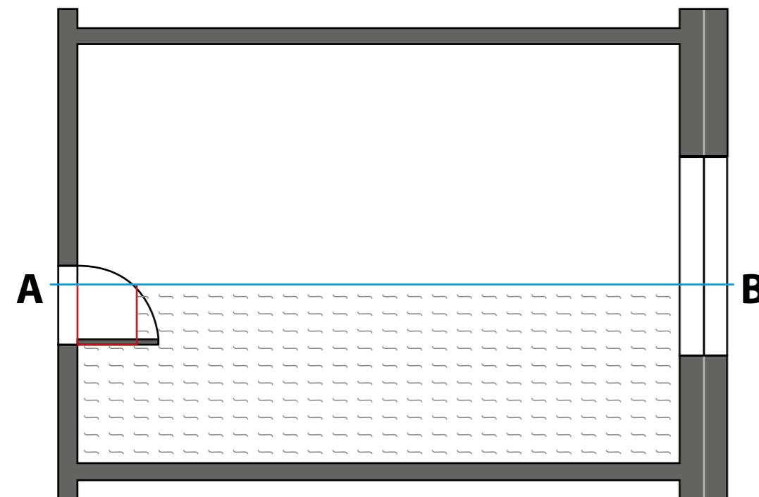
Obr. 2. Naneste lepidlo zubovou stérkou a nechte zavadnout. Jakmile je lepidlo způsobilé k zahájení lepení, položte první dlaždici přesně podél zakládací čáry A-B. Důkladně zatlačte ve středu dlaždice a válečkem nebo rukou vytlačte vzduch směrem od středu ke krajům dlaždice.
