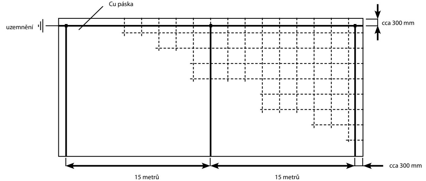
Štětcem se nanese tenká vrstva vodivého disperzního lepidla v šíři cca 3 cm, do které se vtlačí Cu páška. Všechna křížící se místa se proletují podle bodu 9.1.1.1. Vývody měděné pásky se provádějí rozpojitelné, opatřené rozpojitelnou svorkou pro kontrolu elektrického odporu. Tyto vývody jsou napojeny na hlavní ochrannou svorku ČSN 33 2000-5-54 (Uzemnění a ochranné vodiče). Po instalaci vodivé sítě se provede měření odporu R Cu-vodivé sítě. Dále se postupuje dle Kapitol 8.4. až 8.9.
