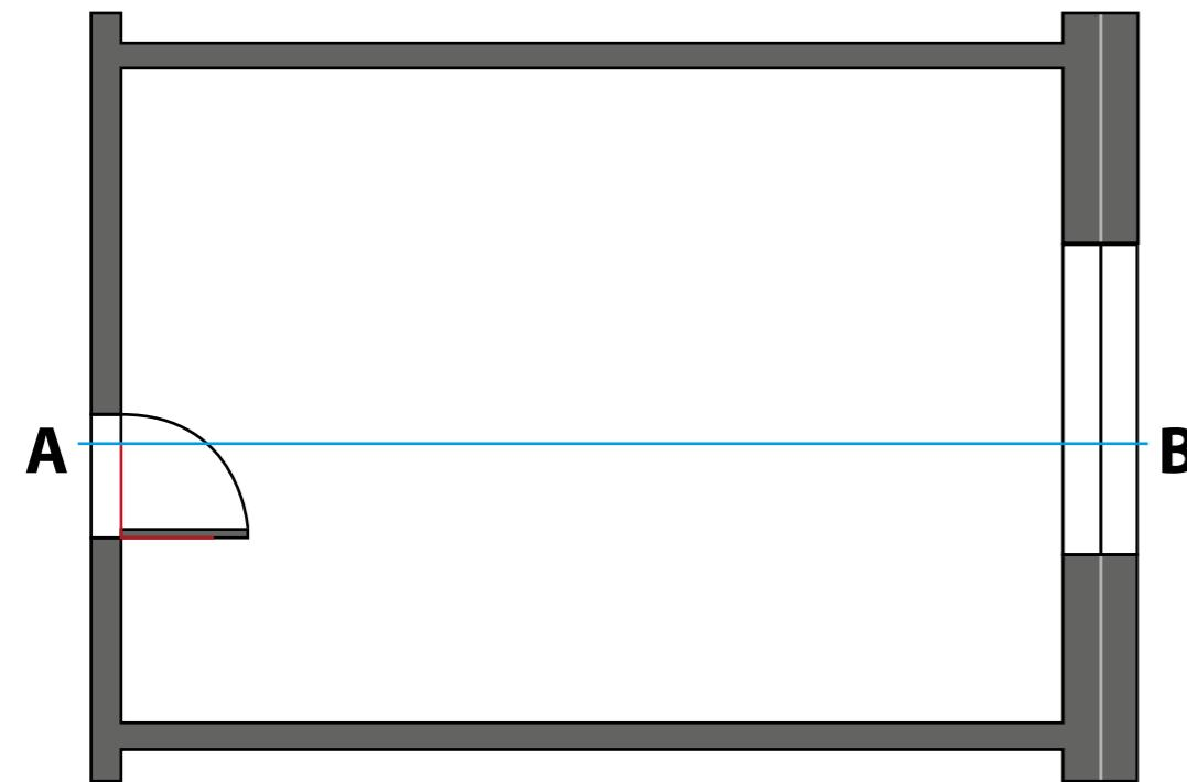
Obr. 1. Podlahu místnosti připravené k pokládce pečlivě rozměrte a vyznačte zakládací čáru A-B.
