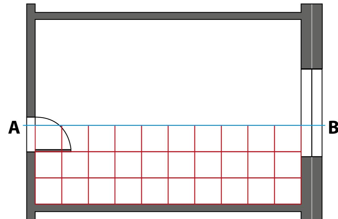
Obr. 4. Položte druhou řadu a zkompletujte celou sekci. Položenou podlahovinu zaválcujte článkovým válcem o hmotnosti min. 50 kg.
