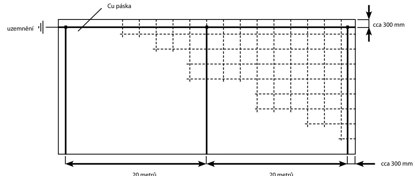
Štětcem se nanese tenká vrstva vodivého disperzního lepidla v šíři cca 3 cm, do které se vtlačí Cu páška. Všechna křížící se místa se proletují podle bodu 9.1.1.1. Vývody měděné pásky se provádějí rozpojitelné, opatřené rozpojitelnou svorkou pro kontrolu elektrického odporu. Tyto vývody jsou napojeny na hlavní ochrannou svorku ČSN 33 2000-5-54 (Uzemnění a ochranné vodiče). Po instalaci vodivé sítě se provede měření odporu R Cu-vodivé sítě.
