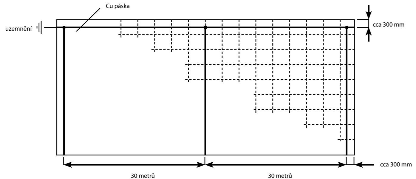
Štětcem se nanese tenká vrstva vodivého disperzního lepidla v šíři cca 3 cm, do které se vtlačí Cu páiska. Všechna křížící se místa se proletují podle bodu 9.1.1.1. Vývody měděné pásky se provádějí rozpojitelné, opatřené rozpojitelnou svorkou pro kontrolu elektrického odporu. Tyto vývody jsou napojeny na hlavní ochrannou svorku ČSN 33 2000-5-54 (Uzemnění a ochranné vodiče). Po instalaci vodivé sítě se provede měření odporu R Cu-vodivé sítě.
